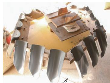
パイプ板に袋を挟み、規定量の春菊を詰め込みます。1回で18袋できます。
